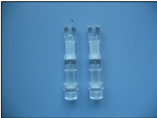
Bild 4: Beispiel für geprüfte Säulenhaltung zum Fixieren der Aktivkohleröhrchen (Foto: R. Wischer)
